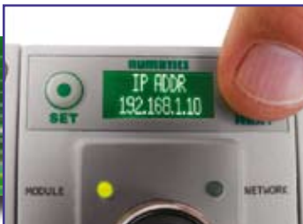
Affichage visuel pour configuration et diagnostic
